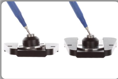
छोटे कोर को रखने के लिए कोर पर उठाए गए मार्करों को 0 डिग्री पर आर्टिकुलेटर प्लेट पर उठाए गए मार्करों के साथ संरेखित करें। इसे स्थिति में डालने के लिए ऊपर एक छोटे टूल का उपयोग करें।
