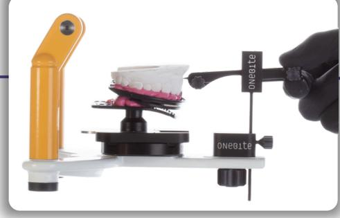
**19** यह चरण उन तकनीशियनों के लिए है जो मिडलाइन को चिह्नित करना चाहते हैं। स्लाइडर को मिडलाइन मार्कर के साथ आर्टिकुलेटर में डालें। स्लाइडर स्क्रू का उपयोग करके मिडलाइन मार्कर को वांछित ऊंचाई पर समायोजित करें। स्टाइलस पेंसिल को निकालें, इसे मिडलाइन मार्कर आर्म्स में डालें, और मिडलाइन को मॉडल पर चिह्नित करें।
