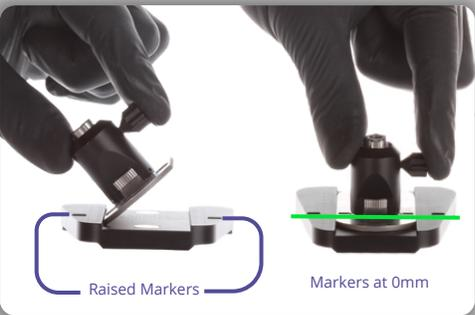
**5** Posizionare il nucleo sulla piastra dell'articolatore allineato ai marcatori in rilievo a 0. Posizionare un lato del nucleo nella corretta posizione a 0 e abbassare l'altro lato per facilitarne il posizionamento.
