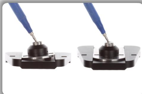
Per posizionare il nucleo corto, allineare i marcatori in rilievo sul nucleo ai marcatori in rilievo sulla piastra dell'articolatore a 0 gradi. Inserire uno strumento piccolo nella parte superiore per farlo scendere in posizione.
