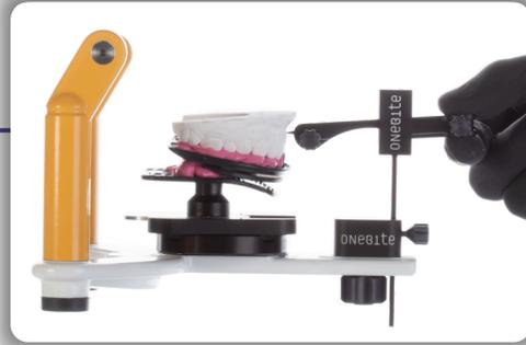
**19** Questo passaggio è per i tecnici che utilizzano lo stilo e desiderano segnare la linea mediana corretta per il montaggio. Inserire lo slider nell'articolatore con il marcatore della linea mediana inserito. Regolare il marcatore della linea mediana all'altezza preferita utilizzando la vite dello slider. Rimuovere la matita dello stilo, inserirla nelle braccia del marcatore della linea mediana e segnare la linea mediana sul modello.
