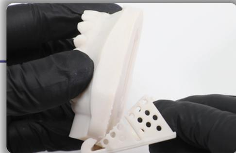
**4** Les supports au bas de chaque modèle peuvent être facilement retirés en tenant fermement le modèle et en rompant la plaque de support.
