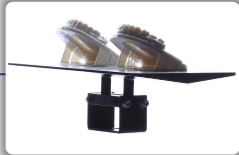
**2** Imprimez les fichiers des arcades supérieure et inférieure. Ces fichiers sont déjà équipés de supports, il n'est donc pas nécessaire d'ajouter des supports supplémentaires. Si votre imprimante indique le contraire, essayez une impression test avec le support fourni avant d'ajouter des supports personnalisés.
