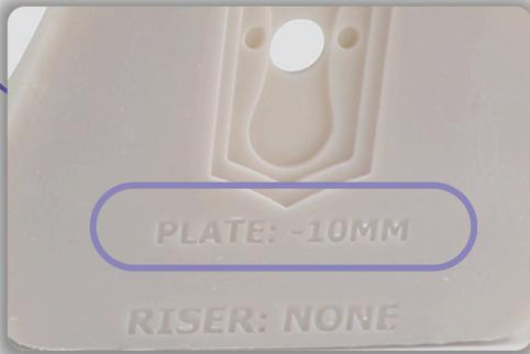
**7** Wenn die Modelle eine Zahl neben „Platte“ anzeigen, richten Sie die erhabene Linie auf der Stahlbasis der Adapter auf die Messung der Artikulatorplatte nach hinten oder nach vorne aus.
