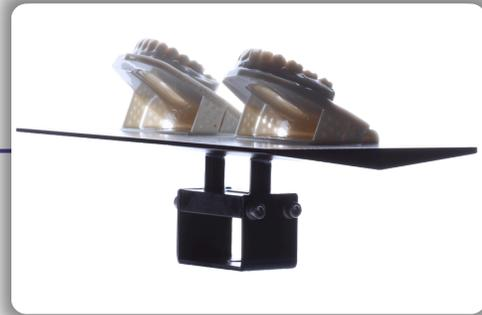
**2** Drucken Sie die Dateien für das obere und untere Modell. Diese Dateien sind bereits mit Stützstrukturen ausgestattet, daher sind keine zusätzlichen Stützen erforderlich. Falls Ihr Drucker etwas anderes anzeigt, versuchen Sie einen Testdruck mit den bereitgestellten Stützen, bevor Sie benutzerdefinierte Stützen hinzufügen.
