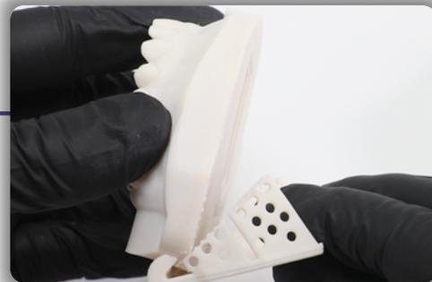
**4** Die Stützen an der Unterseite jedes Modells können leicht entfernt werden, indem Sie das Modell festhalten und die Stützplatte abbrennen.
