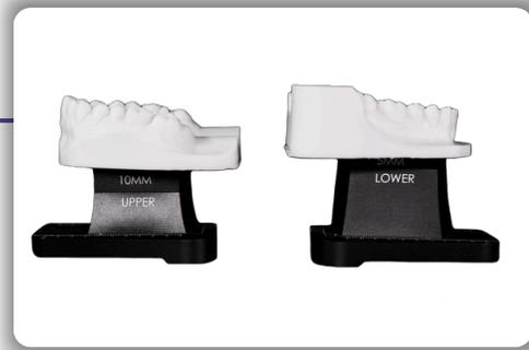
**14** 対応するアダプターにそれぞれの上顎および下顎モデルを固定します。これを行うには、ピンを3Dプリントのパターンに合わせます。
