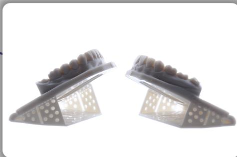
**3** Если дополнительные опоры необходимы, их следует размещать на нижней стороне, избегая узора точных креплений, чтобы предотвратить искажение.
