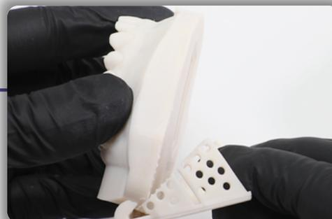
**4** Los soportes en la parte inferior de cada modelo se pueden quitar fácilmente sosteniendo firmemente el modelo y separando la placa de soporte.
