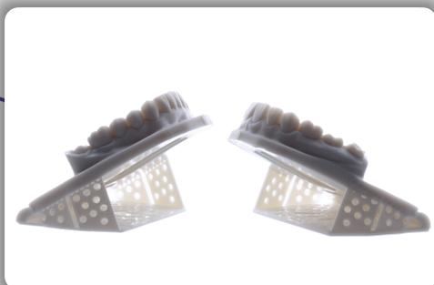
**3** Si se requieren soportes adicionales, deben colocarse en la parte inferior, evitando el patrón de los accesorios de precisión para evitar distorsiones.
