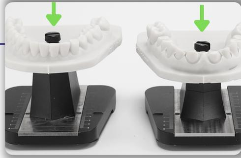
**16** Los tornillos pequeños de dentado se pueden asegurar de la misma manera que los más grandes. Si es necesario, utiliza la ranura del destornillador de cabeza plana en la parte superior para apretarlos más.
